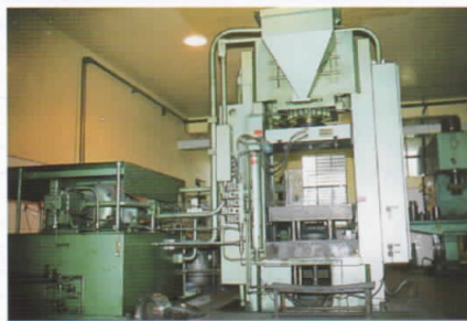
500吨阿尔法压机用于滚环的精密成型 ALPHA press for precision forming of roll-rings
