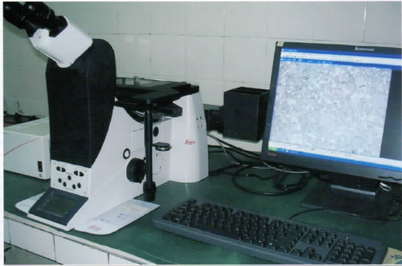
金相显微镜用于合金显微组织结构分析 Microscope for microstructure analyzing
